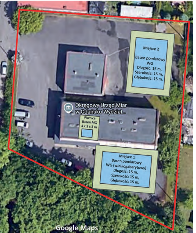
Rys. 2. Wizualizacja wariantów posadowienia basenu wielkogabarytowego (basen WG) na terenie WZ3 OUM Gdańsk Fig. 2. Visualization of foundation options for the large-scale pool (WG pool) at the WZ3 site of the Gdańsk Regional Office of Measures (OUM Gdańsk)
