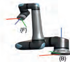
Rys. 3. Cztery warianty rozwiązania odwrotnego zadania kinematyki: a) ramię po lewej, łokieć na dole, nadgarstek do wewnątrz, b) ramię po lewej, łokieć na górze, nadgarstek do wewnątrz, c) ramię po prawej, łokieć na górze, nadgarstek na zewnątrz, d) ramię po prawej, łokieć na dole, nadgarstek do wewnątrz
