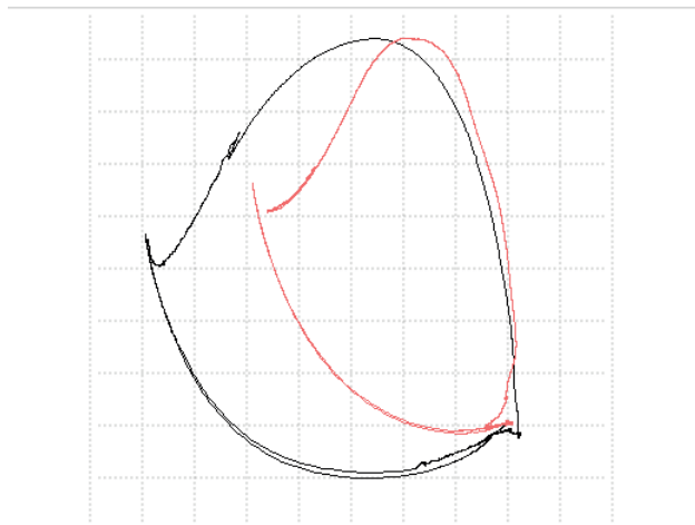
Rys. 4. Wykres impedancji X(R) dla próbki wykonanej ze stopu EN AW-2017 T451
