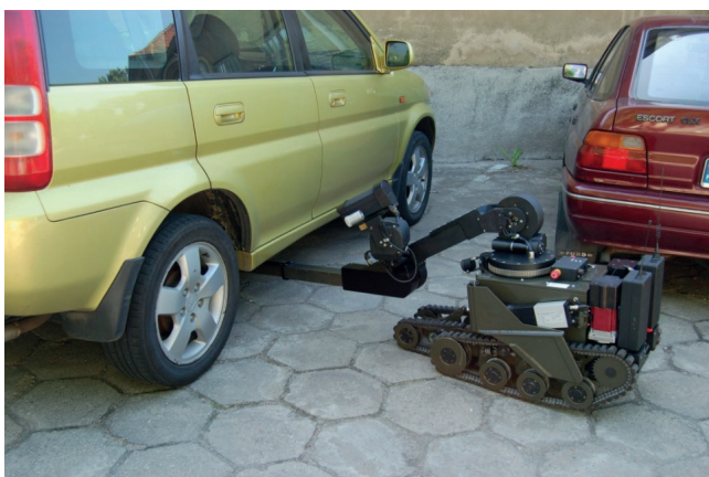
Fot. 5. Robot Expert podejmuje ładunek spod podwozia samochodu Photo 5. Expert robot acquiring a load from underneath a car
