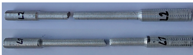
Rys. 11. Próbkki z odlewów oznaczone L1 i L2 po zerwaniu Fig. 11. Casting samples marked L1 and L2 after fracture
