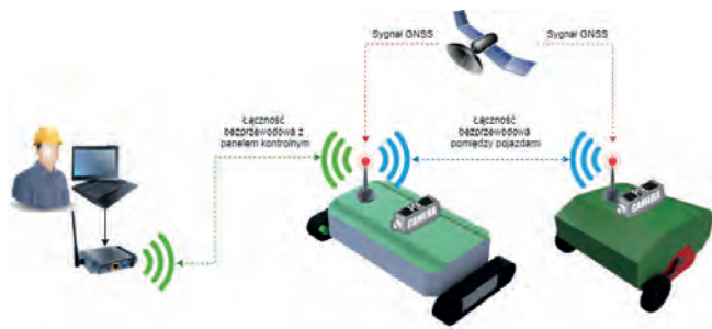
Rys. 3. Konceptcja działania zintegrowanego z użytkownikiem półautonomicznego systemu koszenia
