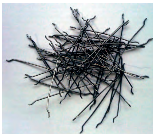
Rys. 2. Włókna stalowe użyte w badaniach Fig. 2. Steel fibre used during the research program
