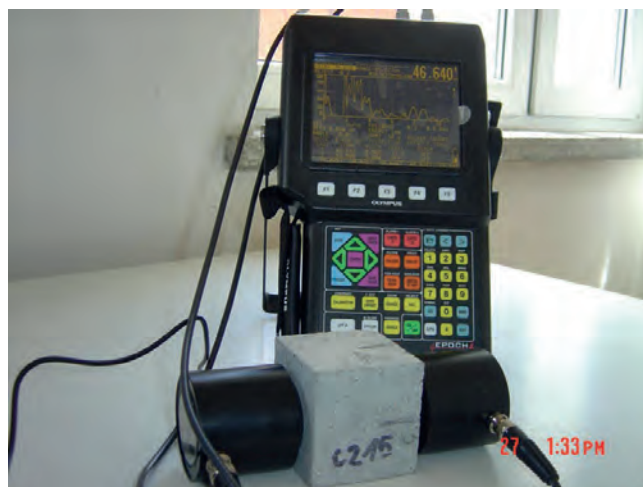
Rys. 3. Defektoskop ultradźwiękowy użyty w badaniach Fig. 3. Ultrasonic defect detector used in the research
