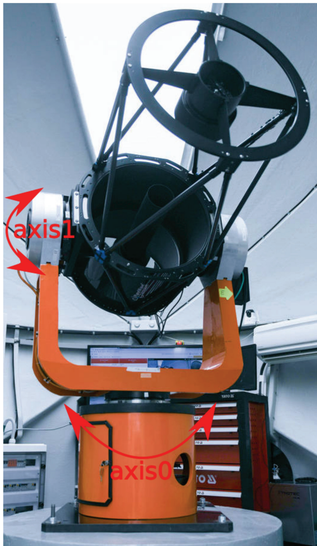
Fig. 1. The mount carrying a 0.5 m class telescope (PlaneWave CDK20 0.51-m f/6.8 Corrected Dall-Kirkham with resolving power 0.28 arcsec and camera FLI PL16803 CCD 4096 × 4096 9 μm pixels with resolution 0.54 × 0.54 arcsec/px and field of view 0.61 × 0.61 deg) used in SkyLab Rys. 1. Montaż z teleskopem klasy 0,5 m (PlaneWave CDK20 0.51-m f/6.8 Corrected Dall-Kirkham z maksymalną zdolnością rozdzielczą 0,28 arcsec oraz kamerą FLI PL16803 CCD 4096 × 4096 9 μm piksele o rozdzielczości 0,54 × 0,54 arcsec/px z polem widzenia 0,61 × 0,61 deg) stosowany w SkyLab
