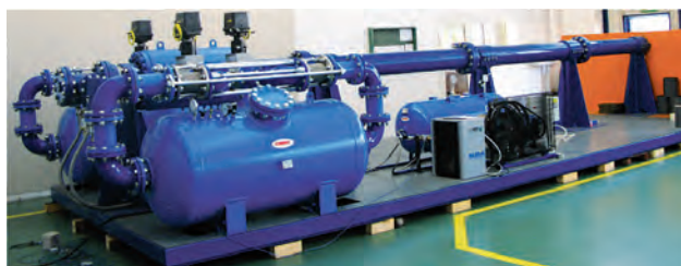
Rys. 7. Działło pneumatyczne kalibru 250 mm
