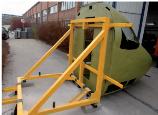
Rys. 13. Zamocowanie kabiny pilotów na statywie stanowiska badawczego
