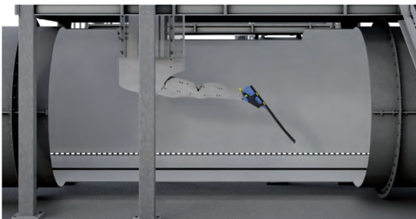
Projekt tunelu wodnego opracowany w ramach projektu „Biodive Fin – innowacyjne biomimetyczne płetwy pływackie dla zastosowania cywilnego”
