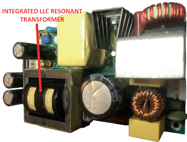
Fig. 20. Constructed integrated LLC resonant converter Rys. 20. Skonstruowana zintegrowana rezonansowa przetwornica impulsowa typu LLC
