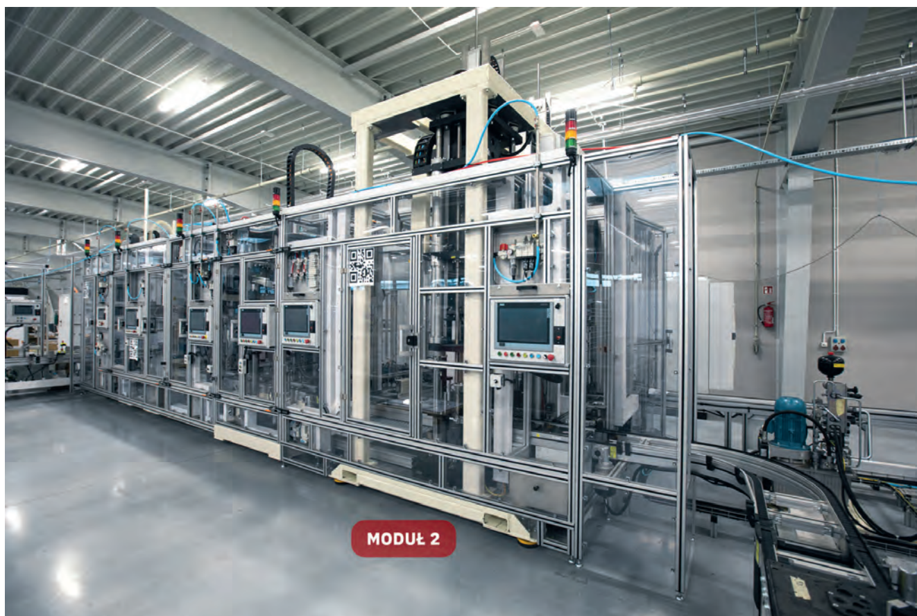
Rys. 4. Zdjęcie CTS jako modułu 2 demonstracyjnej linii do montażu i testowania amortyzatorów
