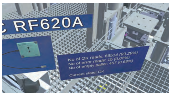
Rys. 6. Cyfrowy bliźniak CTS w okularach rozszerzonej rzeczywistości z wyświetlonymi informacjami o stanie wybranego urządzenia stacji
