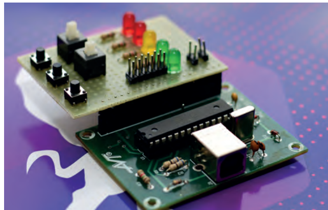
Rys. 9. Wykonanie urządzenia USB z użyciem schematu płytki PCB dostarczonej przez AVT-Korporacja Sp. z o.o. Do urządzenia podłączona jest płytka testowa
