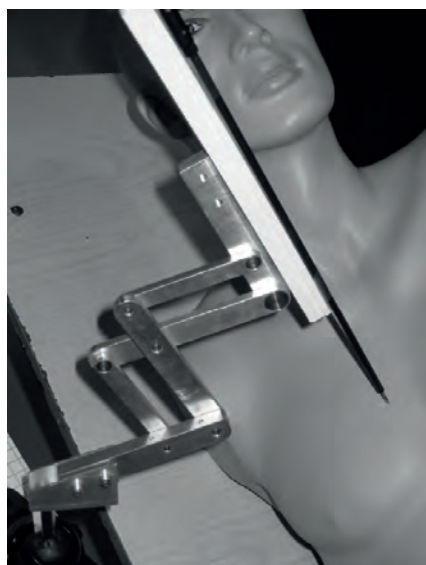
Rys. 14. Model techniczny manipulatora do chirurgii laparoskopowej z odsuniętą osią obrotu (rozwiązanie własne)
