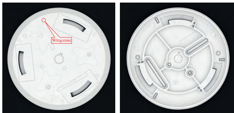
Rys. 1. Przykład detalu polimerowego podlegającego kontroli z zaznaczonym wtrąceniem Fig. 1. Example of an injection molded parts under control with an inclusion
