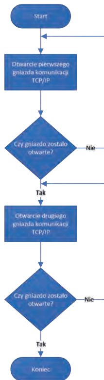
Rys. 2. Algorytm komunikacji między aplikacją VR a programem w URScript
