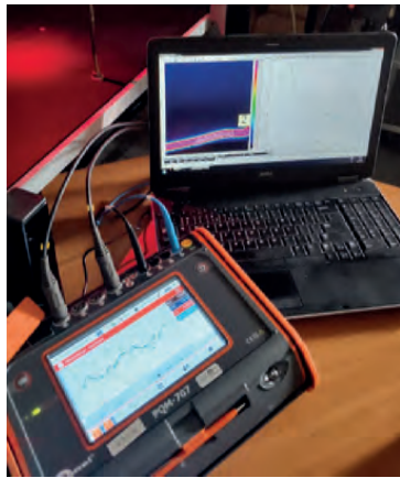
Fig 12. The actual test-bench measuring of RMS current value measurement (AC) Rys. 12. Rzeczywisty stanowisko pomiaru wartości skutecznej prądu (AC)
