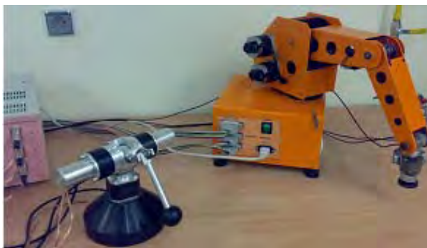
Rys. 4. Dotykowy dżojstik trójosiowy sterujący ramieniem robota Fig. 4. 3-DOF haptic joystick control robot arm
