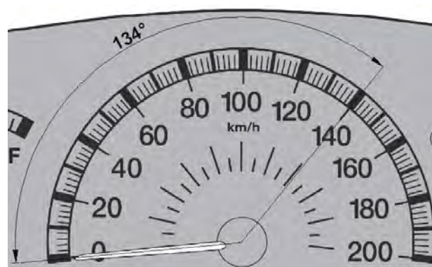
Rys. 11. Minimalny kąt obrotu wskazówki prędkościomierza
