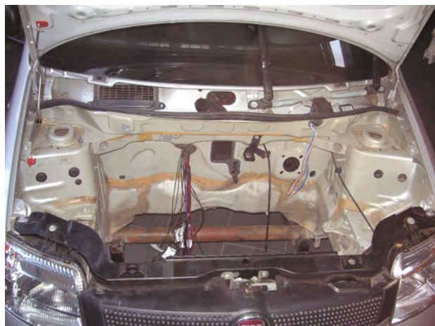
Rys. 4. Przedział silnikowy samochodu po procesie demontażu Fig. 4. The engine chamber after disassembling process
