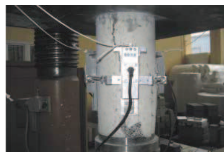
Tensometryczny czujnik przemieszczeń umieszczony na zniszczonej próbce
