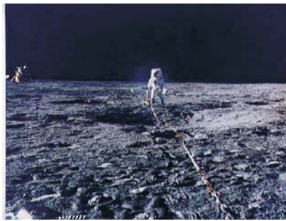
Rys. 1. Alan Bean rozstawia na Księżycu trójosiowy magnetometr transduktorowy w trakcie misji Apollo 12 (fot. za zgodą NASA)
