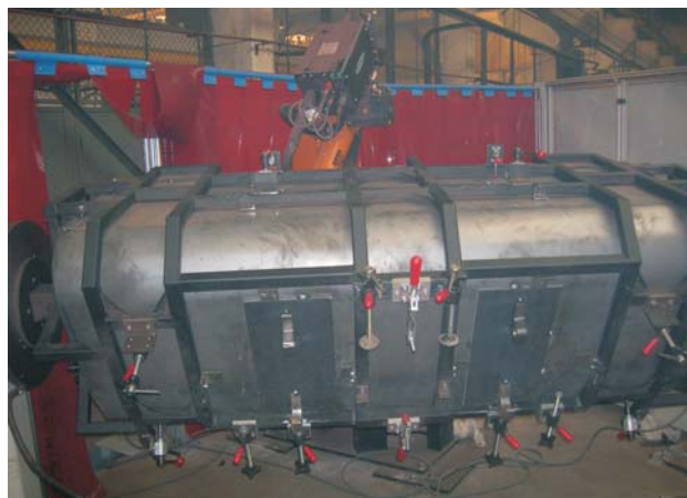
Fot. 3 . Przyrząd spawalniczy z zamocowanym elementem – łyżką do materiałów sypkich
