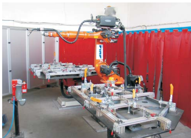
Fot. 1. Zrobotyzowane stanowisko spawalnicze elementów płaskich z dwoma pozycjonerami podwójnymi
