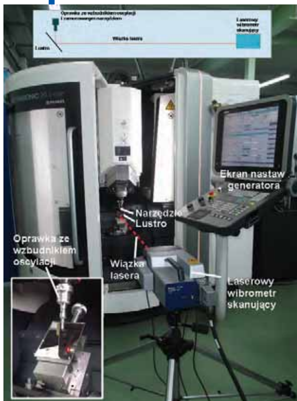
Rys. 2. Konfiguracja obrabiarki i wibrometru dla potrzeb badań Fig. 2. Machine-vibrometer setup for investigations
