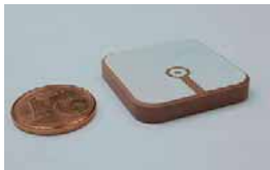
Rys. 14. Zdjęcie przykładowej pasywnej ceramicznej anteny GPS typu „patch” (zdjęcie bez pokrywy ochronnej)
