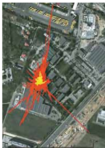
Rys. 17. Porównanie otrzymanych pozycji geograficznych dla odbiorników z anteną SARANTEL SL1206 (kolor czerwony) i anteną typu „patch” (kolor żółty)
