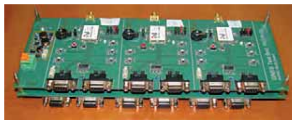
Rys. 8. Zdjęcie płyt testowych z odbiornikami GNSS zastosowanych w przeprowadzonych badaniach
